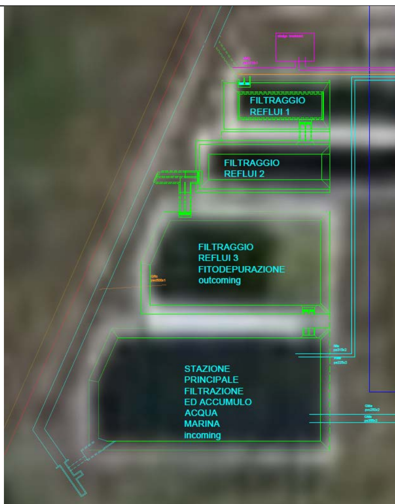
Fig. 5 – Schema dell'impianto di depurazione
