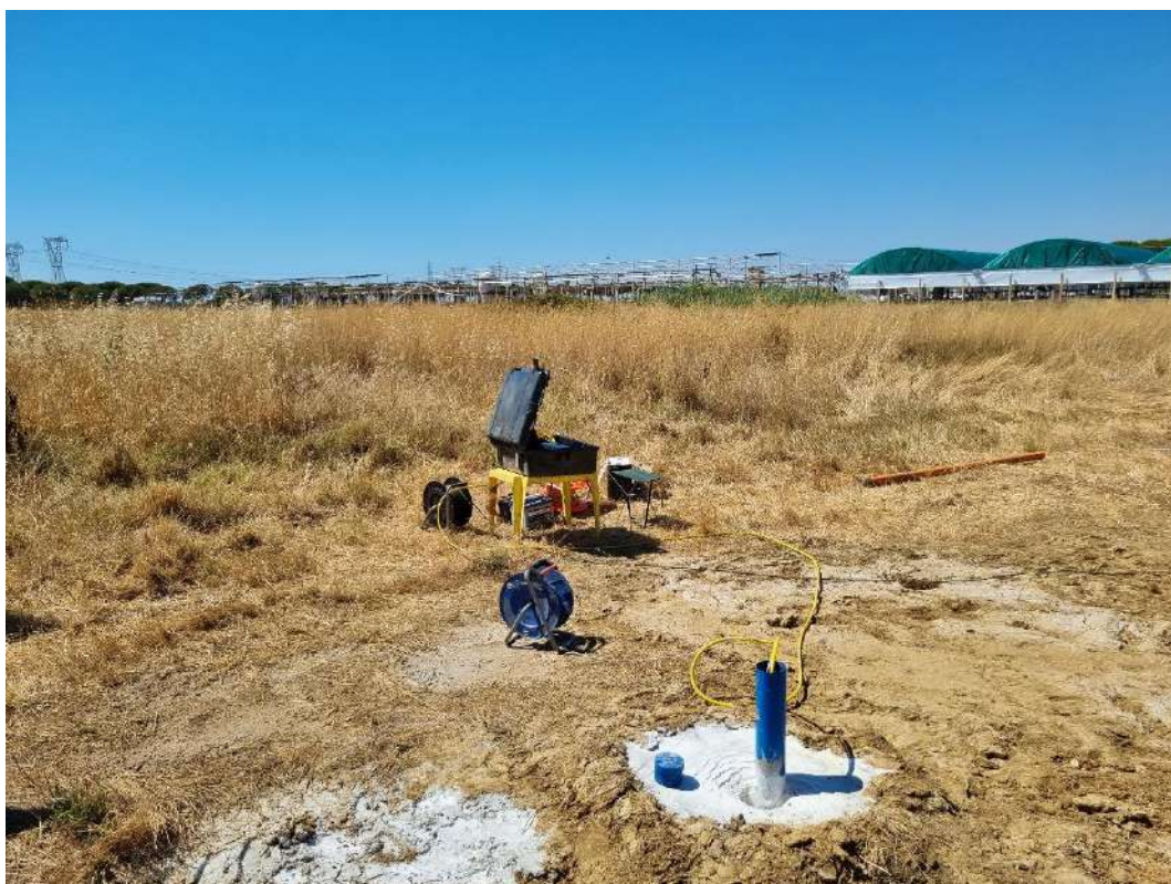
Figura 1: Indagine sismica Down Hole
