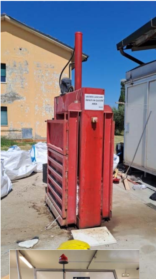
Compattatore Ormic: viene utilizzato in azienda per ridurre il volume degli imballi di plastica e/o big bags
