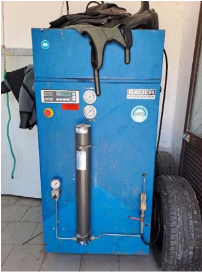
Compressore: viene utilizzato per la sigillatrice nella sezione incassettamento
