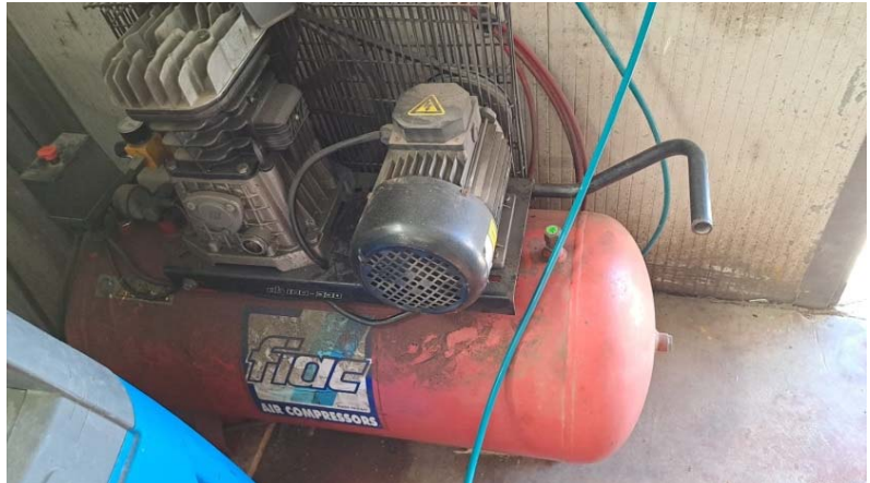
Compressore: viene utilizzato per la sigillatrice nella sezione incassettamento
