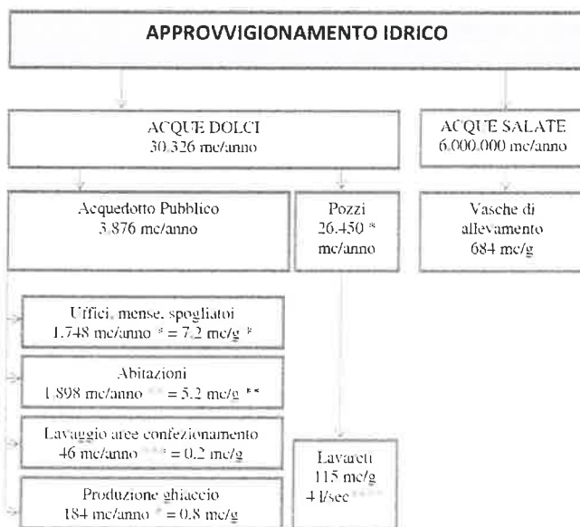
Schema a blocchi dei quantitativi di acqua (fonte: SIA Proponente)
