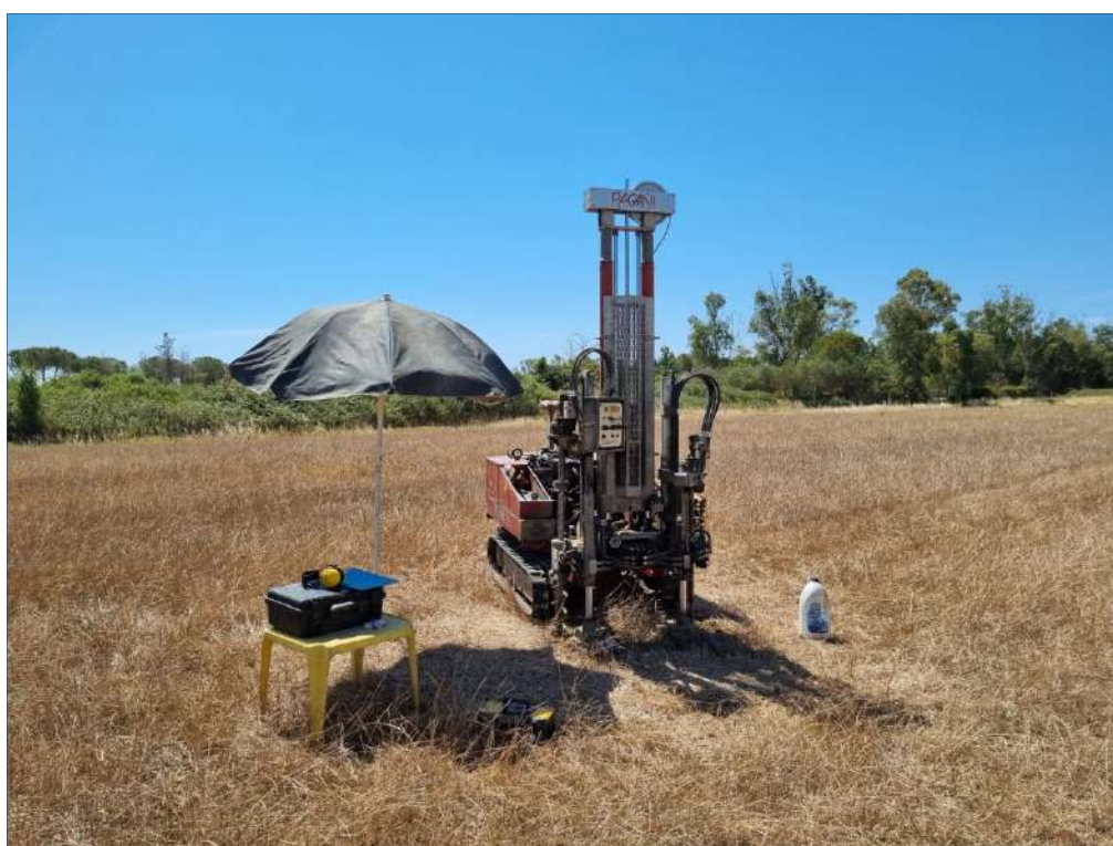
Figura 2: Postazione prova penetrometrica P14
